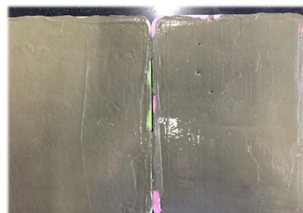
まず、普通のコンクリートを用意します。付着が良くなるようにワイヤーブラシでこすりました。乾燥したコンクリートの上に、セメントペーストと繊維入りセメントペーストを約1センチの厚みで施工。するとすぐに大量のひび割れが発生したため、一度コテでヒビを消したものが右上の写真です。
